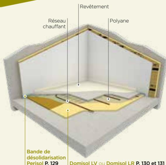
**ISOLATION THERMIQUE SUR PLANCHER BÉTON**
