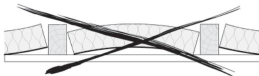
**Figure 18 - Isolation en combles sur plancher bois: pose interdite**
