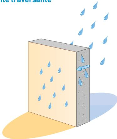
L'humidité traversante constitue un autre problème important : l'eau pénètre à travers les murs le long des joints de la construction, surtout sur les façades exposées à la pluie. Les murs extérieurs sont humides en permanence et au moindre pont de mortier ou élément homogène les traversant, l'eau s'infiltrerait inexorablement et finirait par apparaître sur le mur intérieur.
