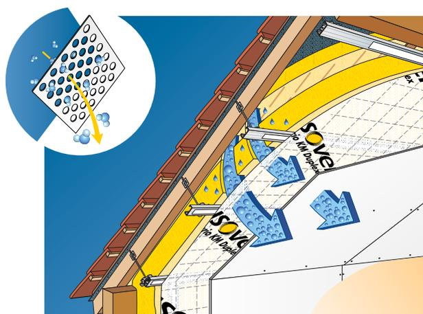
La membrane Vario Duplex est associée aux systèmes Intégra Vario et Intégra Réno. Ils intègrent une gamme d'accessoires spécifiques contribuant chacun à une meilleure étanchéité des points singuliers au contact de la membrane. Intégra Vario et Intégra Réno combinent la membrane Vario avec des isolants spécifiques et un écran HPV permettant des performances thermiques et des **U parois** sans équivalence (cf. solutions pages 76, 77, 80, 89, 90).
