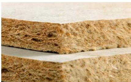
Isonat Plus 55 Flex H est l'isolant en fibre de bois le plus performant du marché :  $\lambda = 0,036 \text{ W/(m.K)}$ . C'est également le seul à posséder un voile assurant un bon confort de pose. Il présente un bon compromis rigidité/souplesse et se calfeutre bien.
