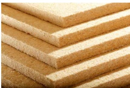
Isonat Flex 40 est un isolant d'entrée de gamme, léger et de bonne qualité. Il possède une bonne performance thermique ( $\lambda = 0,038 \text{ W/(m.K)}$ ), un bon compromis rigidité/souplesse et permet un calfeutrement optimal de la paroi.
