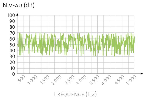
Le spectre du bruit est la représentation des niveaux sonores du bruit en fonction de la fréquence
