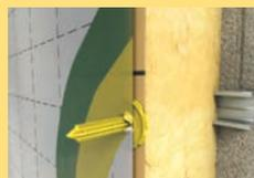
Embrochage de la membrane sur la pointe de l'appui Optima<sub>2</sub> et application de la membrane Vario®. L'étanchéité à l'air est désormais assurée.
