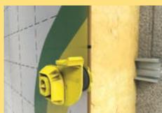
Mise en place de la clef d'en tête de la tige de l'appui Optima<sub>2</sub>.
