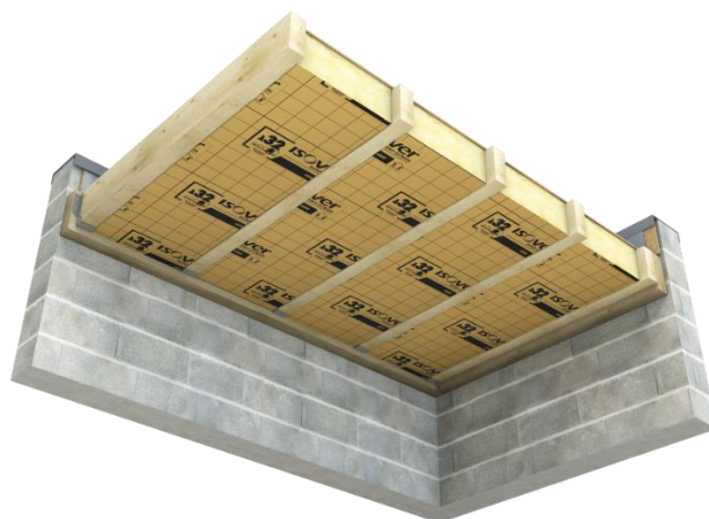
Figure 3 : Pose de l'isolation entre pannes (isolant 1cm plus large que la distance entre pannes).
