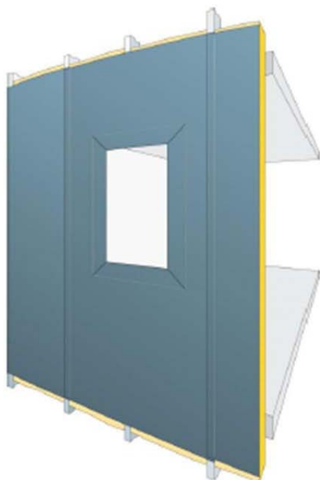
Etape 3 : La partie centrale est enlevée
