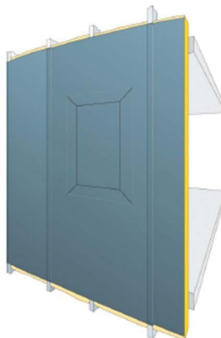
Etape 2 : Pose du pare-pluie
