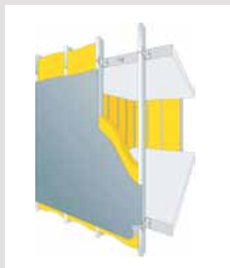
Pose système / Extérieur 5 / pose par-pluie F4
