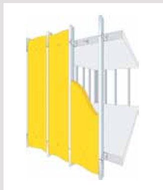
Pose système / Extérieur 4b / pose isolant Isofaçade
