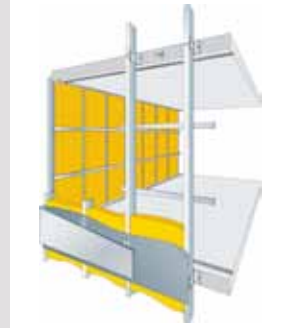
Pose système / Intérieur 2 / pose fourrures Optima horizontales
