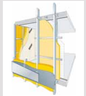
Pose système / Intérieur 7 / pose membrane Vario
