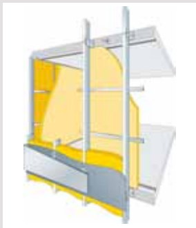
Pose système / Intérieur 4 / pose isolant Isoconfort 32
