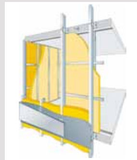
Pose système / Intérieur 6 / pose fourrures Optima verticales
