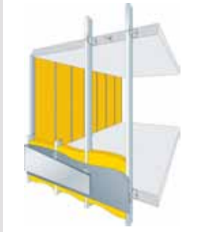
Pose système / Intérieur Structure extérieure existante (poteaux - isolant - par-pluie)
