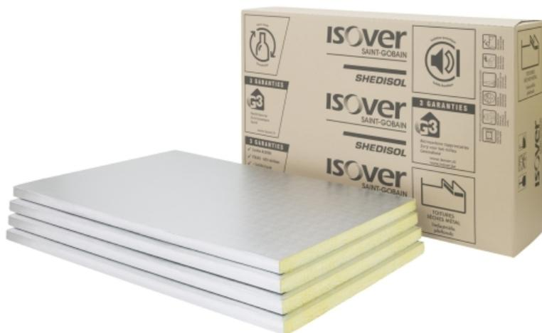
Panneau rigide en laine de verre revêtu d'un pare-vapeur surfacé aluminium utilisable en ERP, renforcé de deux voiles de verres et rebordé sur deux côtés. Incompatible avec l'utilisation de profils Clipshed.
