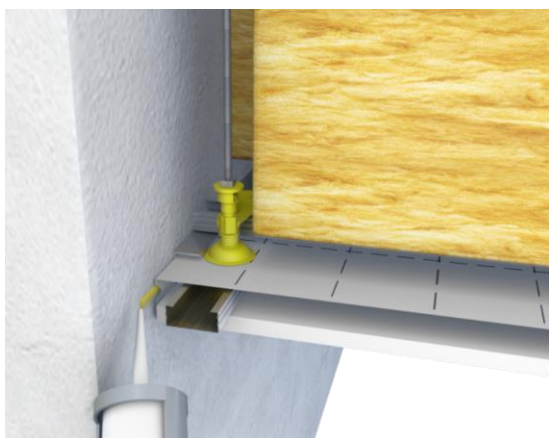
Figure 11 : zoom cavalier + laine à dérouler avec plenum > 70 donc avec les fourrures (clipsées sur les clip plenum INTEGRA 2) perpendiculaires à la paroi et vissées dans la lisse
