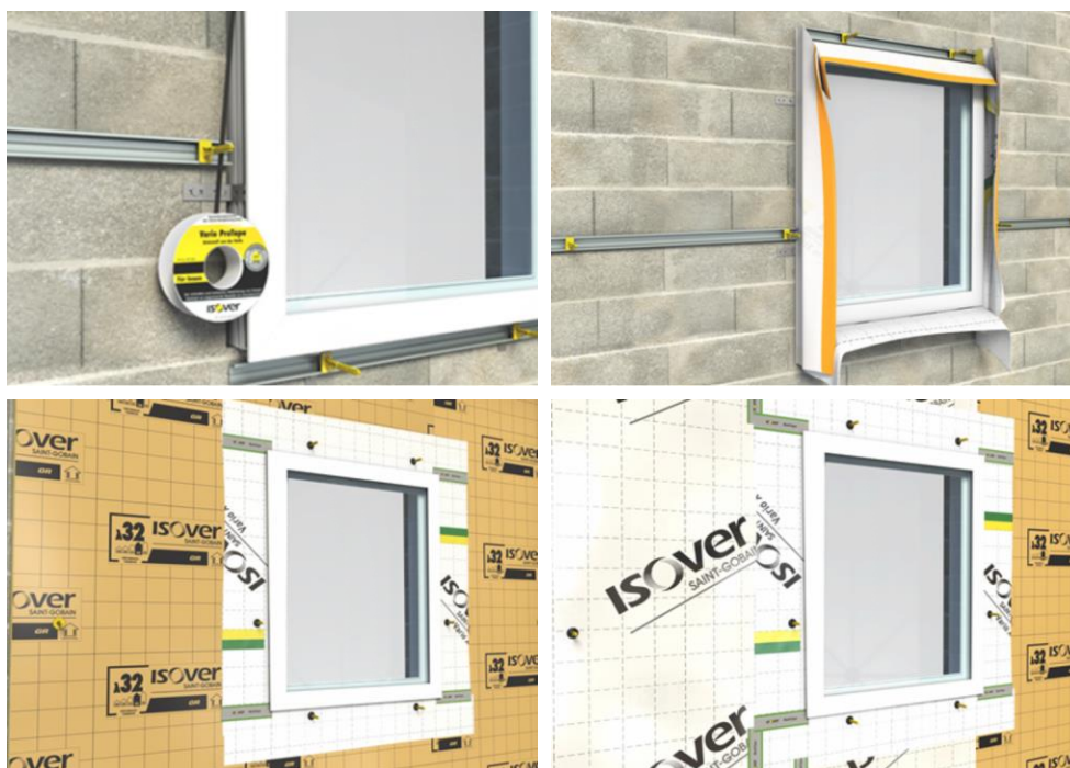
Figure 21 - Entourage des fenêtres posées en applique intérieure avec le VARIO® XTRA BAND.
