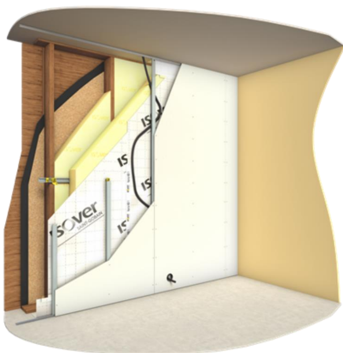
Figure 19 - Pose du système OPTIMA avec la pastille OPTIMA 2 en mur à ossature bois
