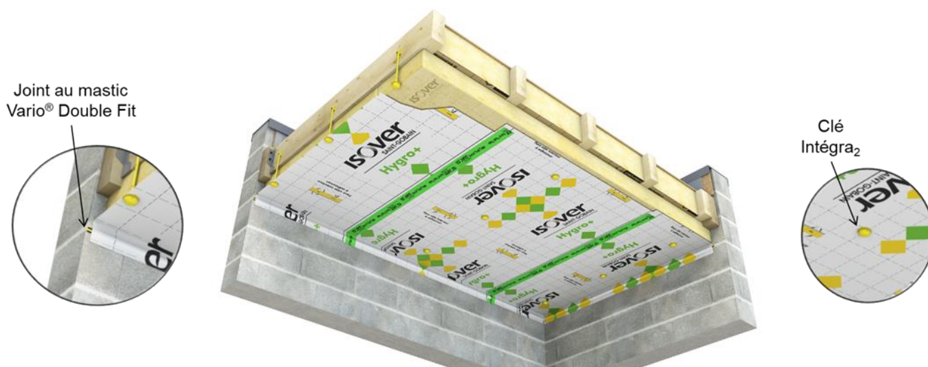
Figure 10 : Pose de la membrane Hygro+, clipsage au maillet des clés des suspentes Intégra 2 , jonction des lés à l'adhésif VARIO® FAST TAPE, jointoiement en périphérie au mastic VARIO® DOUBLE FIT.
