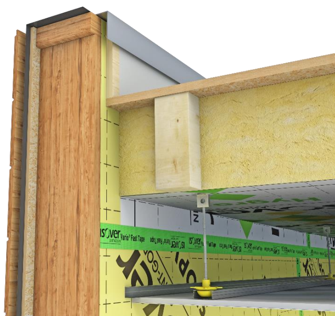
Figure 15 : Jonction de la membrane Hygro+ avec une membrane murale montant dans l'acrotère en MOB sur relief conforme au DTU 43.4
