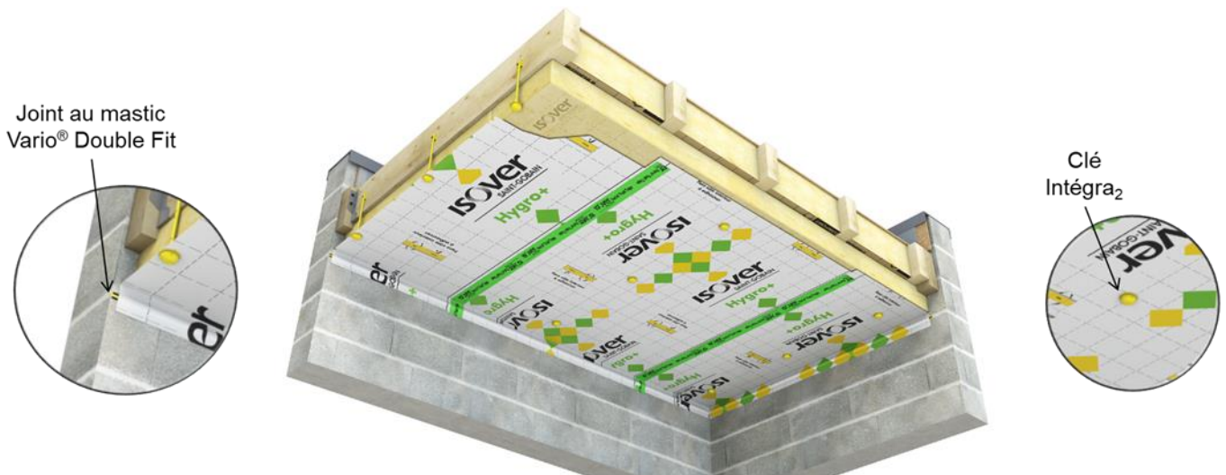
Figure 10 : Pose de la membrane Hygro+, clipsage au maillet des clés des suspentes Intégra 2 , jonction des lés à l'adhésif VARIO® FAST TAPE, jointoiment en périphérie au mastic VARIO® DOUBLE FIT.
