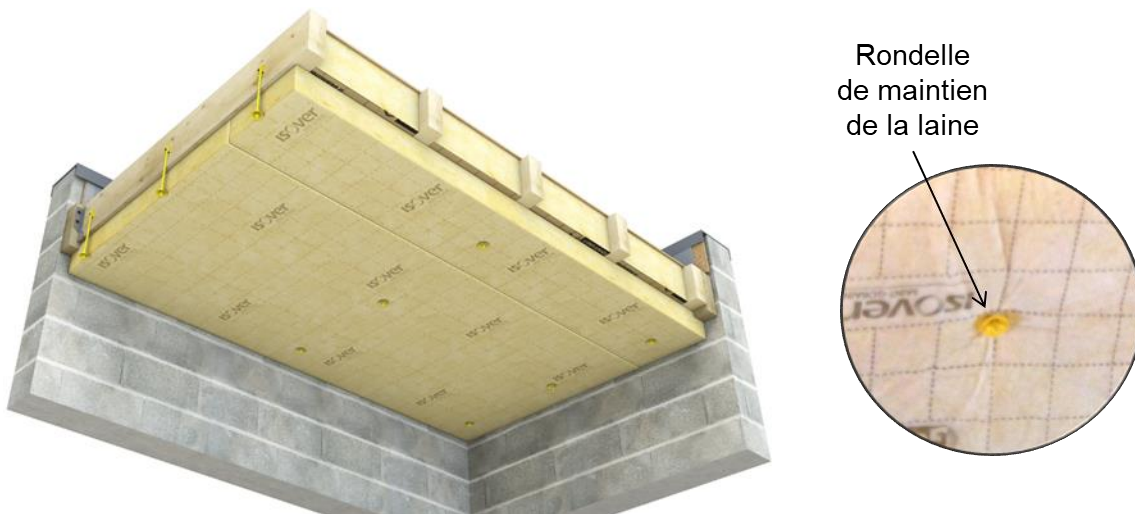
Figure 9 : Pose de la 1ère couche d'isolation entre pannes et de l'éventuelle seconde couche, sous les pannes, embrochée sur les suspentes Intégra 2 . Puis pose des rondelles Intégra 2 sur les suspentes pour tenir la laine de verre.
