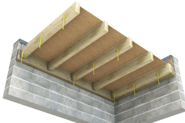
Figure 9 : Pose de la 1ère couche d'isolation entre pannes et de l'éventuelle seconde couche, sous les pannes, embrochée sur les suspentes Intégra 2 . Puis pose des rondelles Intégra 2 sur les suspentes pour tenir la laine de verre.
