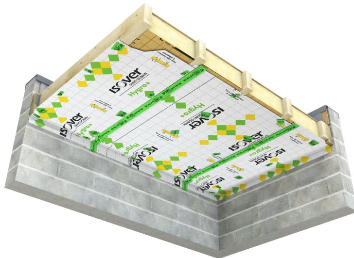
Figure 4 : Pose de la membrane Hygro+ sous la semelle des pannes, par agrafage, jonction des lés et protection des agrafes à l'adhésif VARIO® FAST TAPE ou MULTITAPE, jointolement en périphérie au mastic VARIO® DOUBLE FIT.
