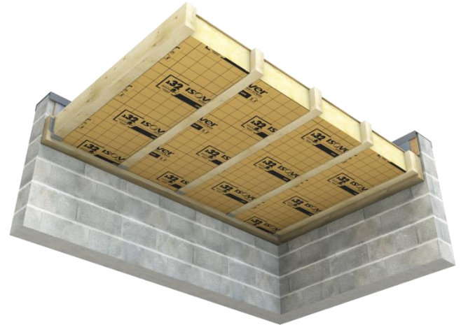
Figure 3 : Pose de l'isolation entre pannes (isolant 1cm plus large que la distance entre pannes).
