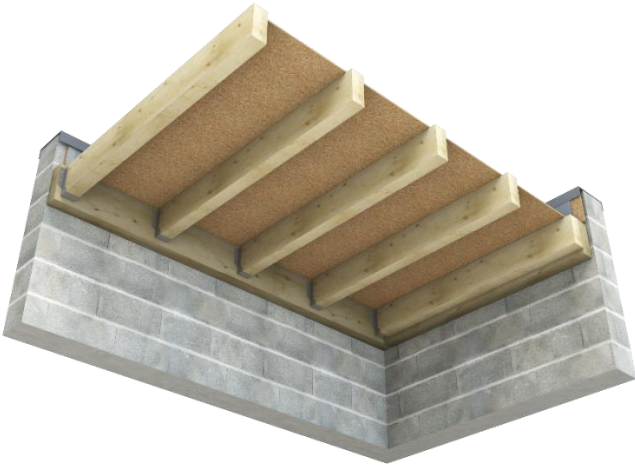
Figure 2 : Solivage, élément porteur bois, couverture et membrane d'étanchéité extérieure posés.
