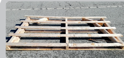
Palette acceptée sous conditions : 2 planches cassées max
