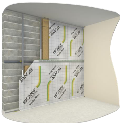
Figure 3-3 : Mise en place de la membrane pare-vapeur Vario® Xtra sur l'ossature métallique à l'aide de double face
