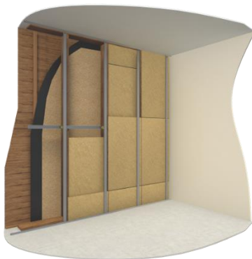
Figure 5-3 : Pose des fourrures métalliques verticales et de la seconde couche d'isolant entre fourrures.
