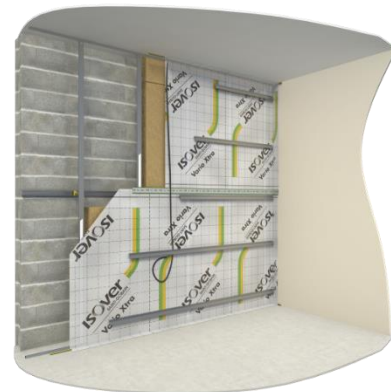
Figure 3-4 : Mise en place des profilés métalliques Stilmob et des gaines électriques
