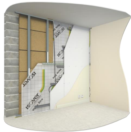
Figure 4-3 : Mise en place des profilés métalliques Stilmob et des gaines électriques et Pose des plaques de plâtre
