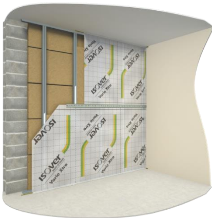
Figure 4-3 : Mise en place de la membrane pare-vapeur Vario® Xtra sur l'ossature métallique à l'aide de double face
