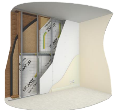
Figure 5-3 bis : Pose de la fourrure intermédiaire et des appuis Optima 2 clipsés. Pose des fourrures métalliques verticales puis celle du parement de finition
