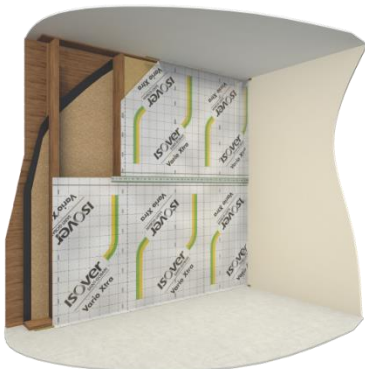
Figure 5-2 bis : Variante de pose de la membrane Vario® Xtra via agrafage sur montants bois et une seule couche d'isolant
