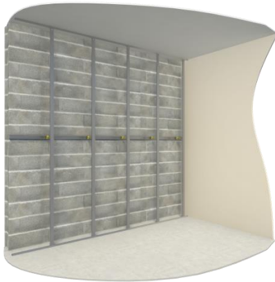
Figure 3-1 : Pose de l'ossature métallique Optima (Lisses, Fourrures, Rallonges et appuis Optima 2 )
