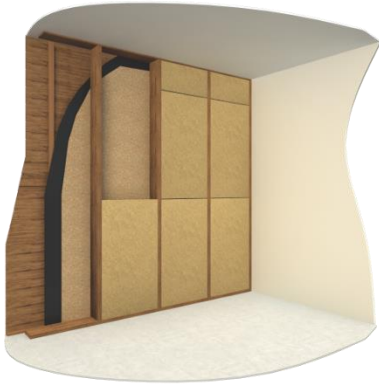
Figure 5-1 : Pose des isolants ISONAT FLEX entre montants bois
