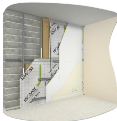
Figure 3-5 : Pose des plaques de plâtre
